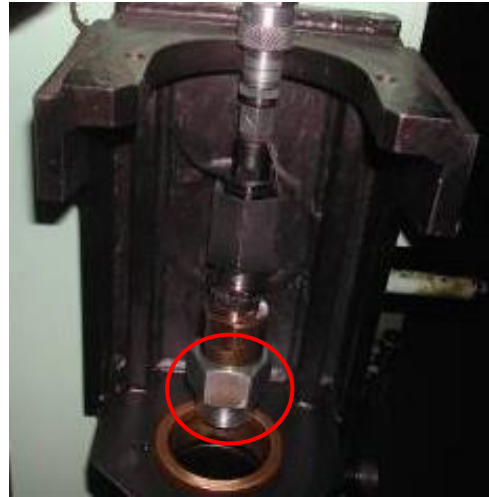
試壓至 90 kg/cm 2 完全不漏
